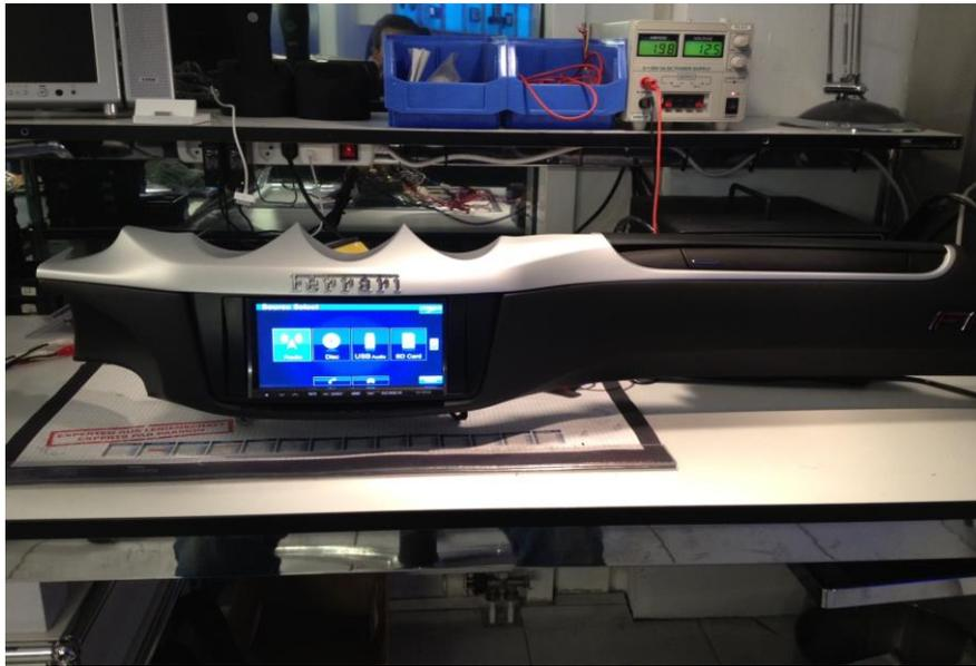
*Alpine Doppel-DIN Gerät eingepasst in Ferrari Cockpit.*
