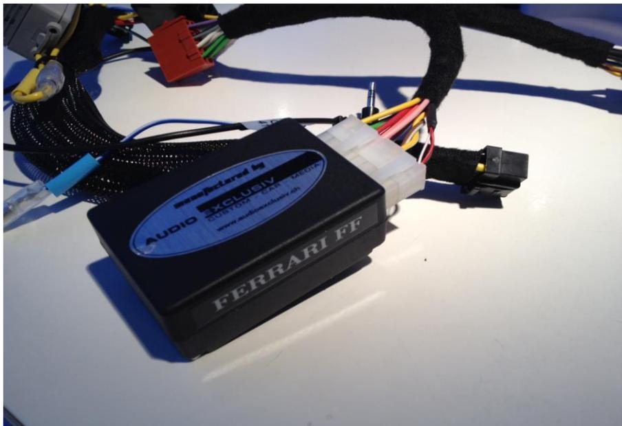
*Unser CAN-Bus mit Anbindung an Lenkradfernbedienung.*
