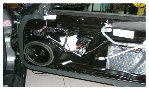
20 cm Woofer in den Türen mit massiver Aufnahme und Tür-Bedämmung.
