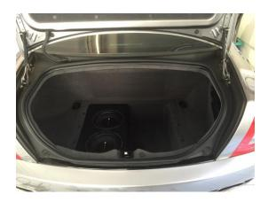
Kofferraum-Subwoofer in einem auf Maas gefertigtem Gehäuse mit Endstufe integriert.
