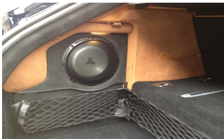
Gehäuse nach Maß angefertigt und mit Alcantara beledert.
