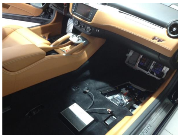
Die zusätzliche Endstufe unter dem Sitz platziert.
