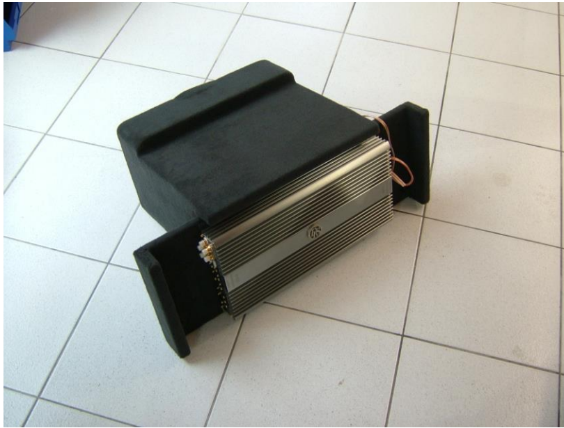
Kraftpaket, Endstufe ist im Bass-Gehäuse integriert.
