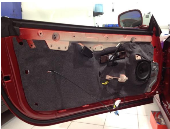
Die Türen werden komplett gedämmt
