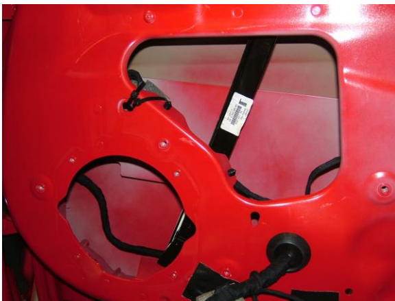
Türe Original ohne Bedämmung.
