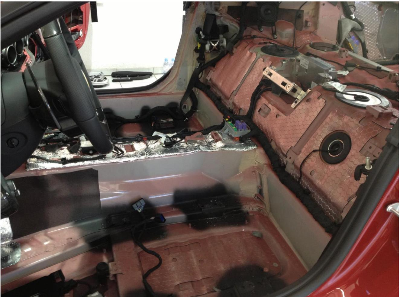
*Original Ausrüstung ohne Bedämmung*
