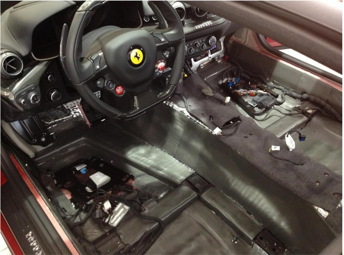
*Bedämmung mit der zweiten Lage.*
