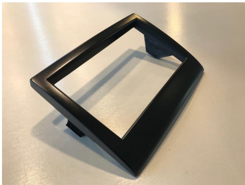
Radioblende Ferrari 612 (Spezialanfertigung aus dem 3D Drucker)
