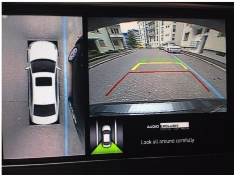
Top-View Kamera-System.. Ansicht der Heckkamera.
