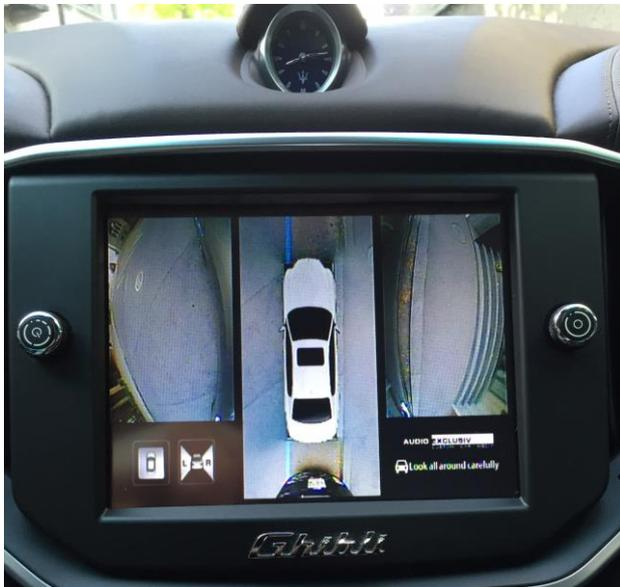
Top-View Kamera-System.. Ansicht der Seitenkameras..
